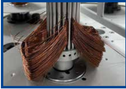
導入定子自動繞線設備
